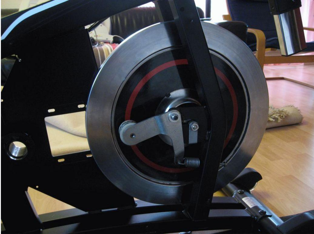
Ja, genau! Der Riemen fehlt. Also noch mal auseinander, den Riemen auf den Antrieb legen und wieder zusammenschrauben. Dann den Riemenspanner wieder montieren.
