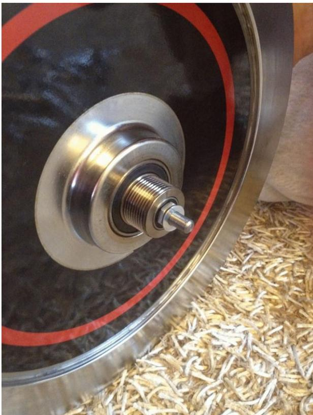
Zur Demontage des Freilaufkörpers am besten zuerst die Achse demontieren. Dazu die Kontermuttern der Lager abschrauben und die Achse mit einem Gummihammer oder einem Holzklotz herausschlagen. Dann habt ihr schon mal die Achse und ein Lager in der Hand. Dann am besten das andere Lager von der gegenüberliegenden Seite mit einem Holzstab herausschlagen.
